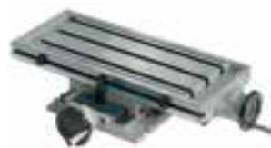
600 XY Table de coordonnées à vis. X = 400 mm. Y = 180 mm. Poids net de la table = 52 kg. Disponible pour séries Z/X(32-34) .
